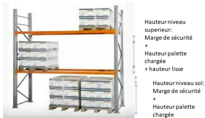
FIGURE 3.13 – Calcul des hauteurs des niveaux d'un palettier
