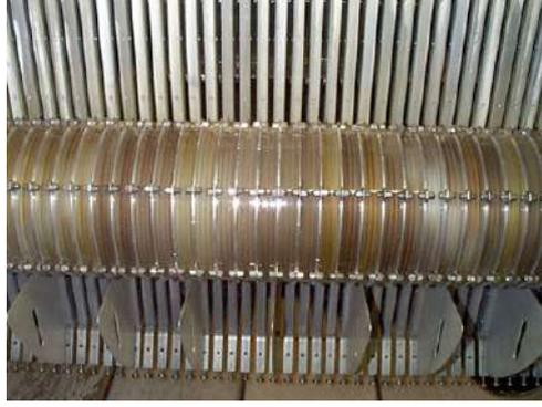
Figure 8 – Les Anneaux du tube d'accélération d'un VDG de l'Université de Washington, États-Unis.
