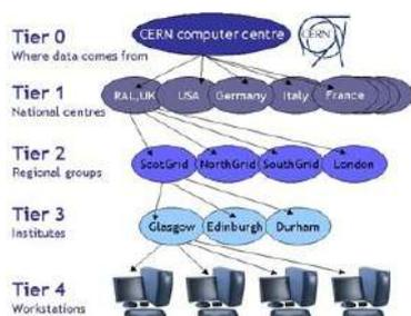
Figura 12: Modelo jerárquico de la computación del Experimento ATLAS.
