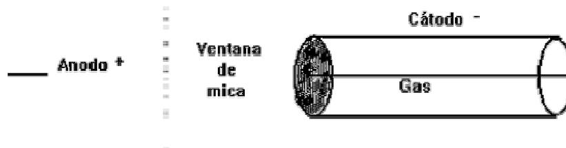
**Figura 10** - Esquema de la cámara de ionización del detector Geiger-Müller
