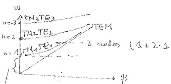
Intervalo ( $w$ ) de propagación monomodo → modo fundamental TTEM
